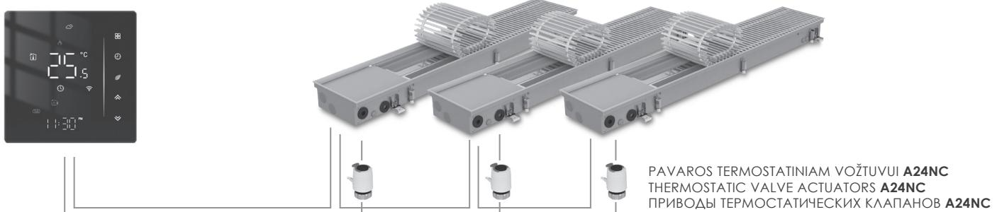
**EL. PAJUNGIMO SCHEMA | WIRING DIAGRAM | СХЕМА ПОДКЛЮЧЕНИЯ**
