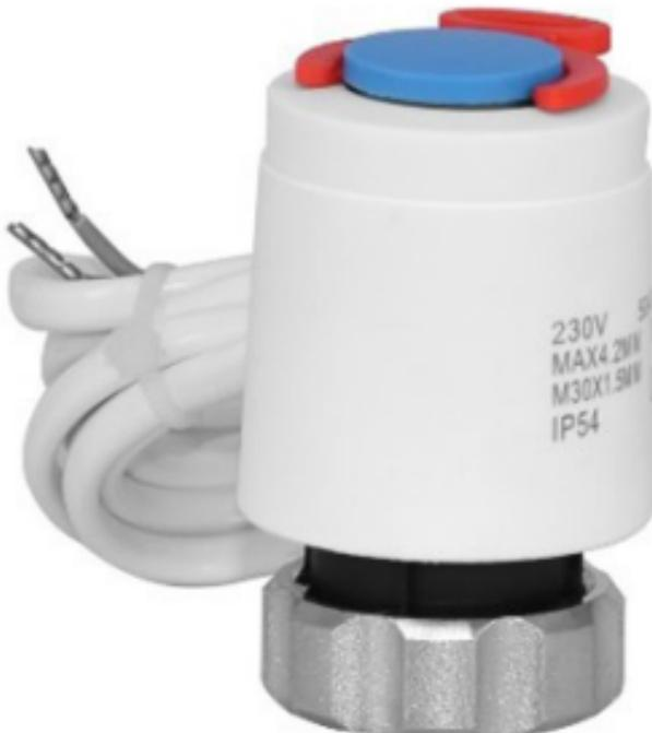
Электротермический привод A24NC (нормально закрытый) предназначен для управления терmostатическими клапанами или коллекторами в системах отопления и охлаждения. Он управляет с помощью контроллера, выдающего сигнал включено/выключено, или переключателем.
