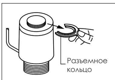
Если электропривод был разобран и разъемное кольцо удалено, разъемное кольцо может быть повторно установлено на электропривод через 3 минуты после подачи питания на электропривод.
