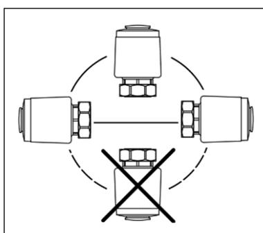
Клапан с электроприводом может быть установлен в горизонтальном положении или смотреть вверх. Установка с электроприводом, смотрящим вниз, не допускается.
