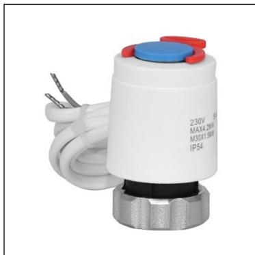
Термоэлектрический привод A24NC, к (нормально закрыт), предназначен для управления терmostатическими клапанами или коллекторами в системах отопления и охлаждения. Его можно управлять с помощью контроллера или переключателя.
